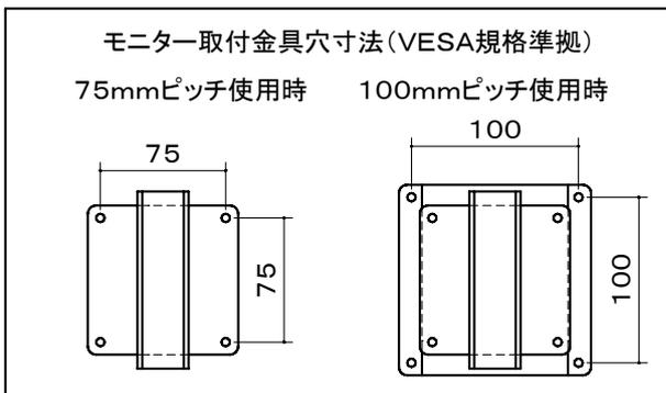
※1 当製品の取付可能モニターはVESA規格の取付ピッチに対応したモニターとなります。(75/100ピッチ兼用)
