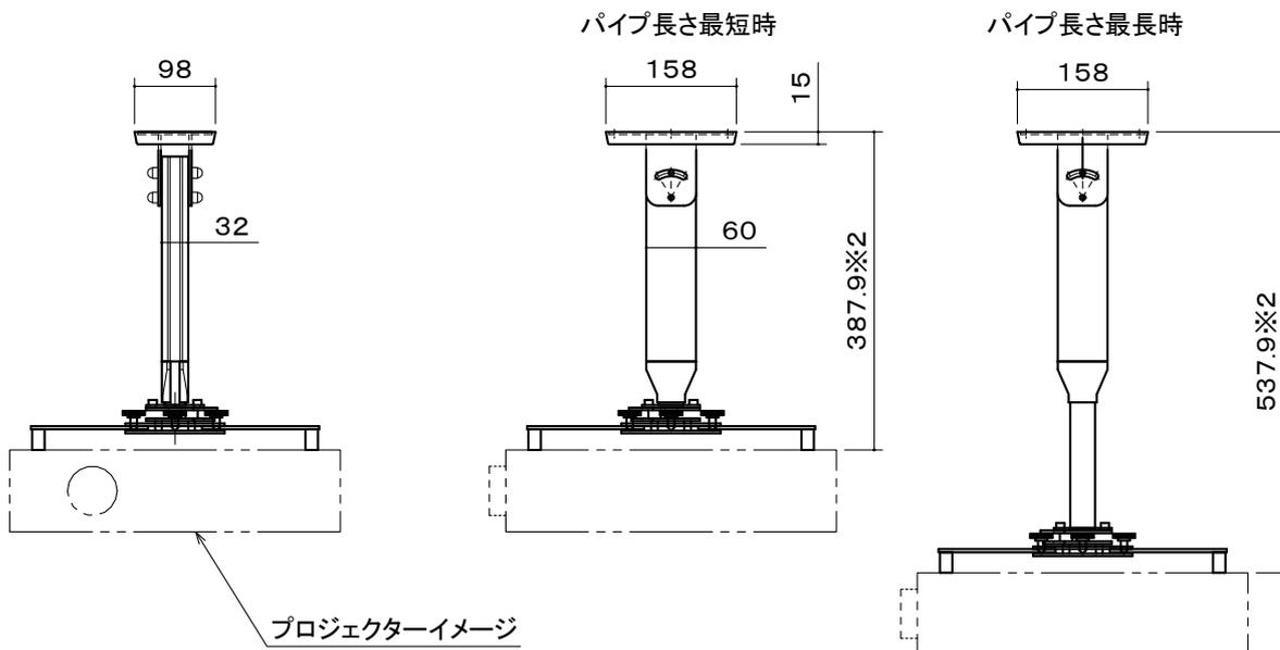
※1 プロジェクターの取付穴ピッチは、アームの回転半径と、その長穴のスライド幅によって決まります。
